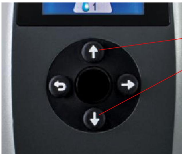
Halten Sie die Auf- und Abwärtstasten gedrückt, um in den Trocknungsmodus zu wechseln.
