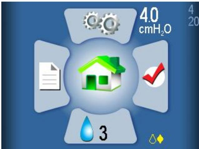
Bei diesem Befeuchter sollte nur destilliertes Wasser verwendet werden. Ein blinkender gelber Tropfen und ein gelber Diamant zeigen an, dass anderes als destilliertes Wasser im Behälter erkannt wird. Der Befeuchter kann weiterhin verwendet werden, obwohl dies bei jeder Art von Wasser, das nicht destilliert ist, die Lebensdauer des Heizgeräts verkürzt und die Garantie für das Heizgerät aufheben kann. Ursachen:
